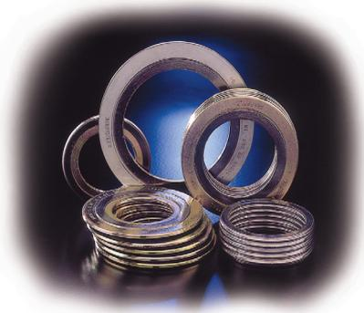
Las juntas espiro metálicas MONTERO BELPAFLEX son realizadas con laminas de metal en forma de “ V “ preformadas y enrolladas alternativamente en forma de “ espiral “ con material de relleno y sellado, proporcionando una alta resiliencia y recuperación y dependiendo de los materiales utilizados en su construcción, una alta resistencia química y térmica, pudiendo alcanzar tanto temperaturas criogenicas como los 1000°C ( API fire safe disponible)
